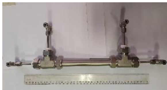
Рис. 3. Опытный образец коаксиальной электролизной ячейки
