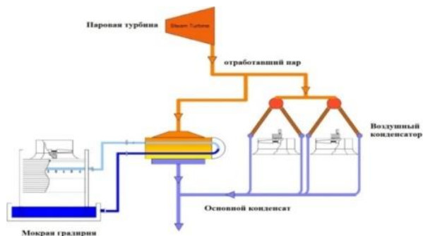
Рисунок 7. Гибридная система охлаждения в купе с воздушным конденсатором.
