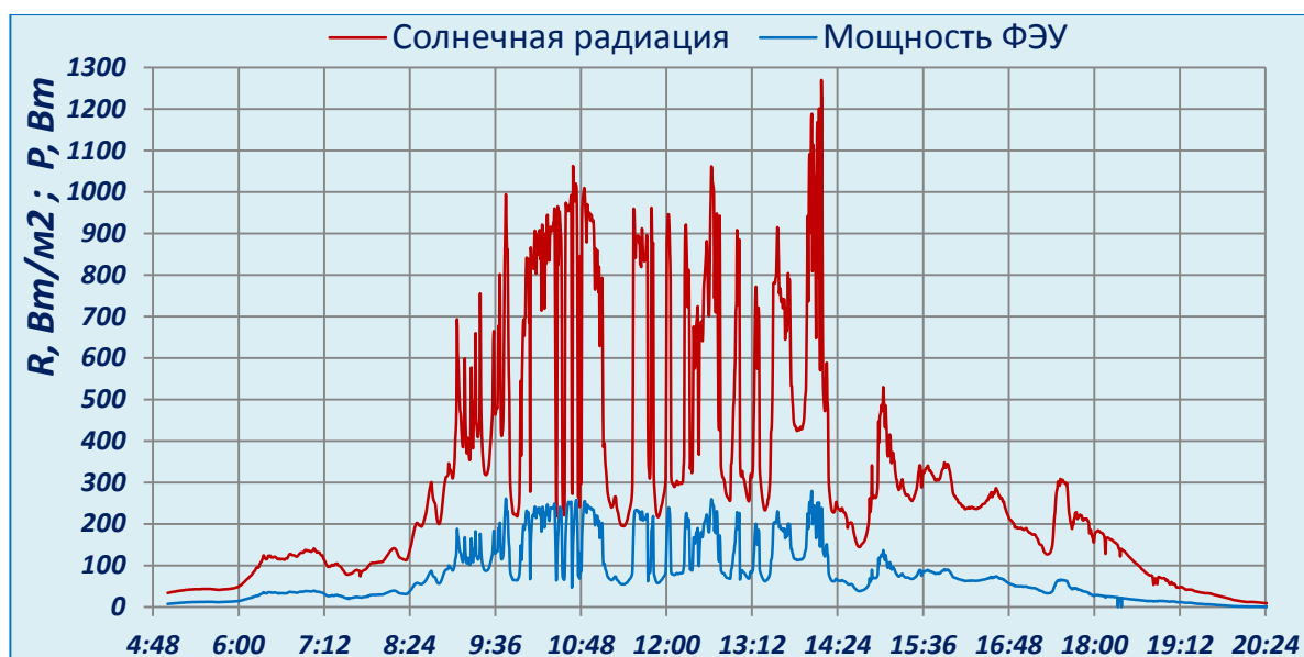
Рис. 1. Мгновенные значения солнечной радиации и мощности ФЭУ.
