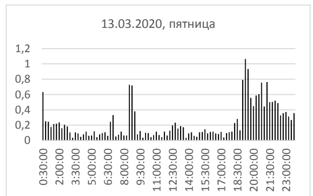
Рис. 18. График потребления на вводе в квартиру за 13.03.20, кВт.
