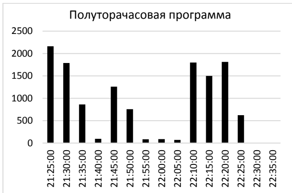
Рис. 4. График потребления посудомоечной машины, полуторачасовая программа, Вт.
