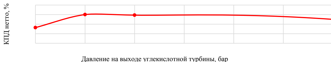
Рис. 8. Влияние давления на выхлопе газовой турбины на КПД нетто цикла SCOC-CC при давлении на входе в паровую турбину 90 бар.
