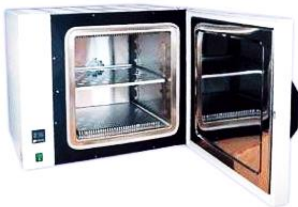
Рис. 3. Низкотемпературная печь Snol 58/350 с принудительной воздушной конвекцией
