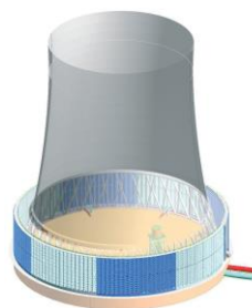
Рисунок 6. Градирня с установленными вертикально по окружности основания дельтами.
