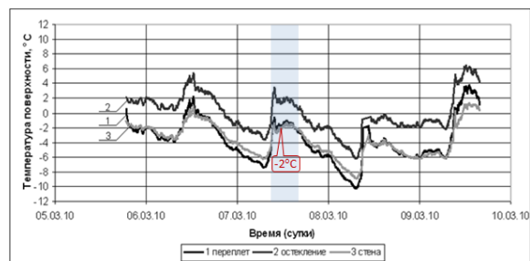
Рис. 2.3. Изменение локальных значений температуры на внешних поверхностях элементов наружного ограждения во времени
