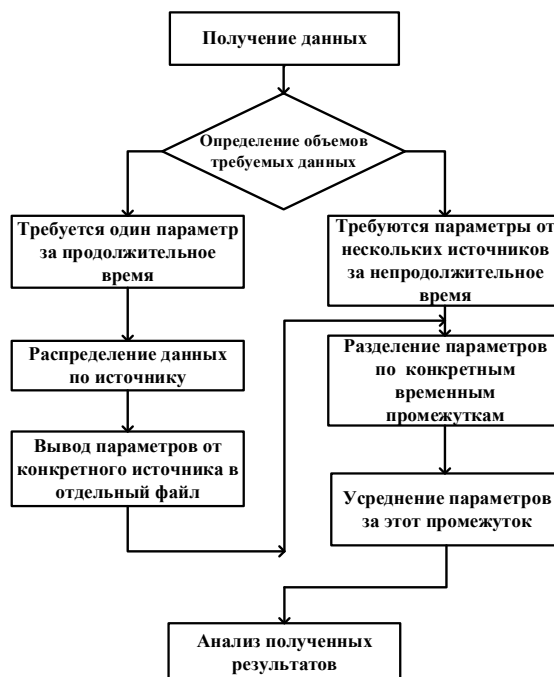
Рис.4 Алгоритм обработки данных из системы Тепломонитор
