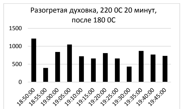
Рис. 9. График потребления разогретого духового шкафа, 220 °С 20 минут, после 180 °С, Вт.
