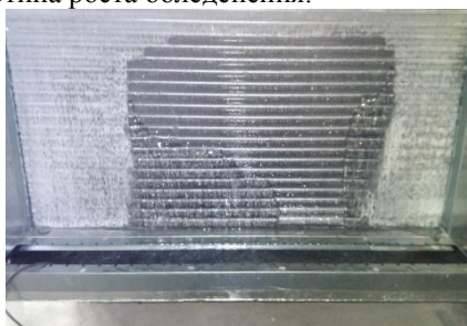
Рис. 5 Картина обледенения теплообменника при работе в течении 250 мин. (обледенение затронуло 80% поверхности).
