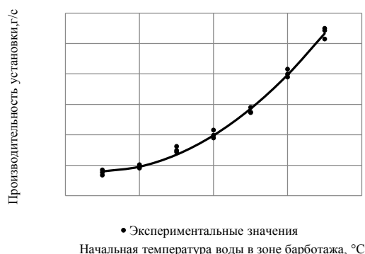
Рис. 2. Зависимость производительности установки от начальной температуры воды в зоне барботажа.
