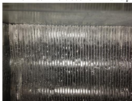
Рис. 6 Форма наледи в зоне отрыва капель.
