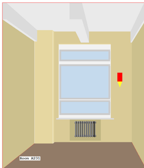
Рис. 2.5. Помещение A231. Место замера температуры отмечено карандашом. Толщина наружной стены справа от окна 0,72 м, а слева – 0,84 м, в нише – 0,42 м.
