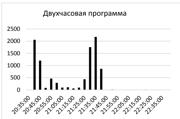
Рис. 5. График потребления посудомоечной машины, двухчасовая программа, Вт.
