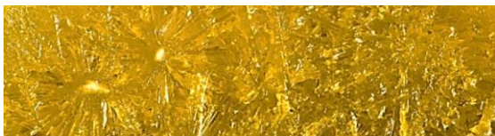
Рис. 4. Структура поверхности серы при большом значении \Delta t .
