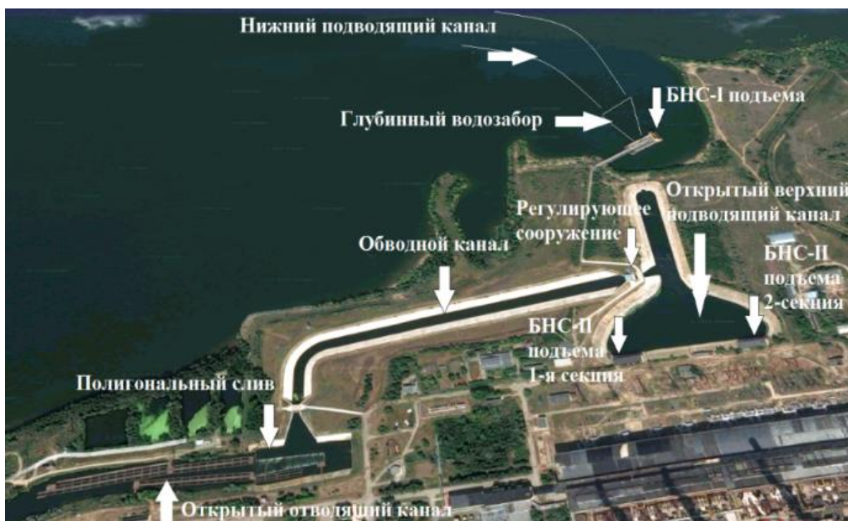
Рис. 2. Схема технического водоснабжения Ириклинской ГРЭС
