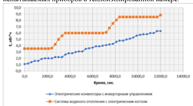
Рис. 2 График потребляемой энергии при нагреве теплоизолированной камеры с 16 °C до 35 °C по средне-объемной температуре
