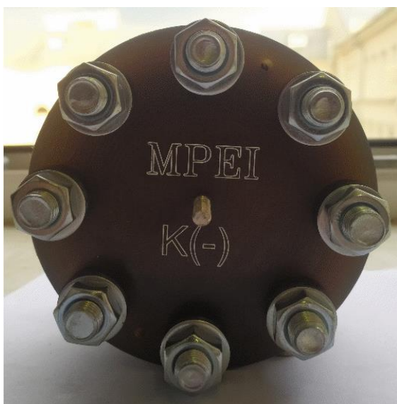
Рис. 2. Собранная электролизная ячейка (катодная сторона)
