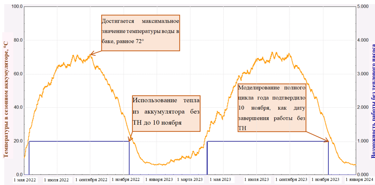
Рис.8. График температур в сезонном аккумуляторе
