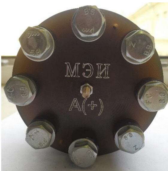
Рис. 1. Собранная электролизная ячейка (анодная сторона)
