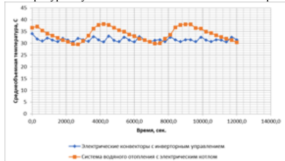
Рис. 4 Колебания средне-объемной температуры при поддержании в теплоизолированной камере постоянной температуры в условиях постоянных тепловых потерь
